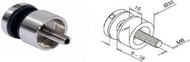
BC045 Pontmegfogó, furat nélkül, szálcsiszolt 6-10 mm-es üveghez
